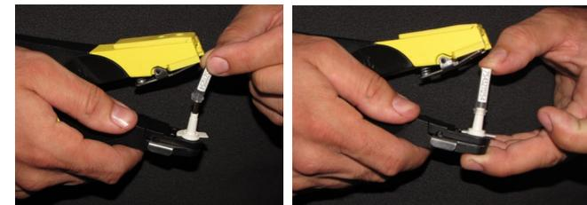
Poser le tube ③ sur l'aiguille et l'encliqueter sur le support aiguille avec les doigts.
