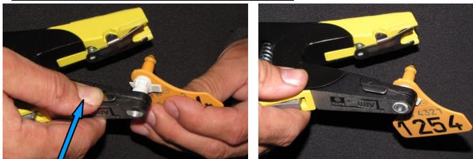
Appuyer sur le verrou situé sur le côté de la pince. Insérer la pièce mâle ① et relâcher le verrou. La pièce mâle est en place.
